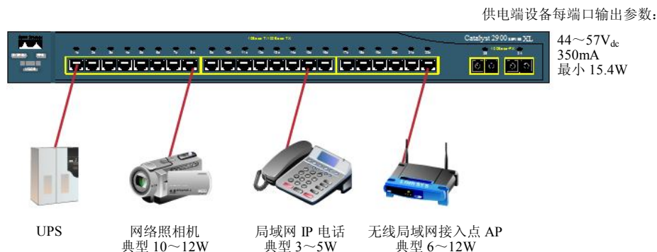
图 3-44 以太网供电连接图
