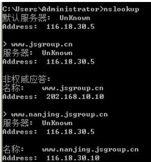
图 3-55 子公司域内 DNS 服务器测试解析域名
