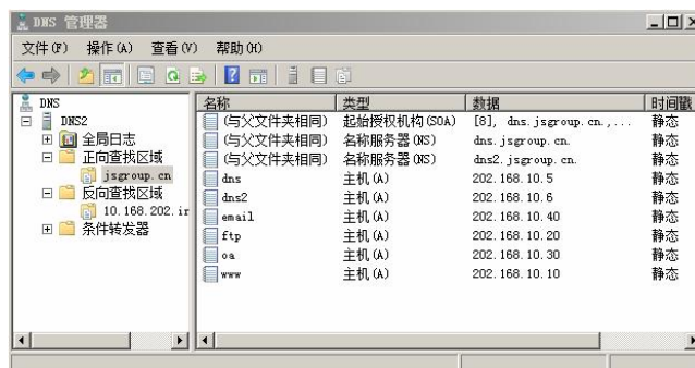
图 3-35 辅助服务器正向区域与主服务器同步
