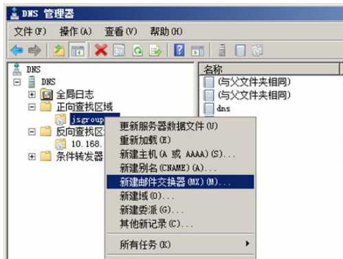
图 3-25 新建邮件交换器
