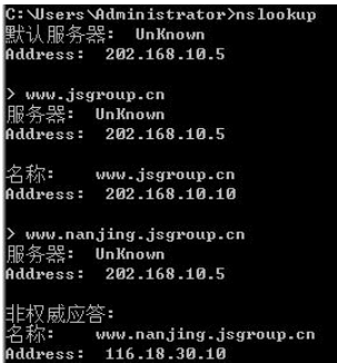
图 3-54 总公司域内 DNS 服务器测试解析域名
