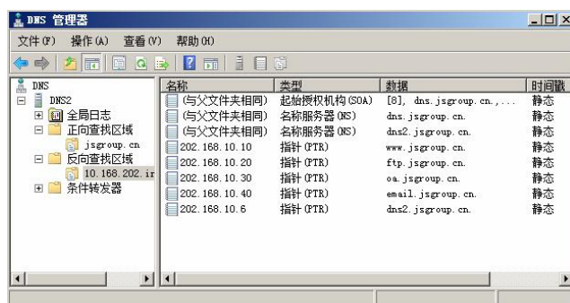
图 3-36 辅助服务器反向区域与主服务器同步
