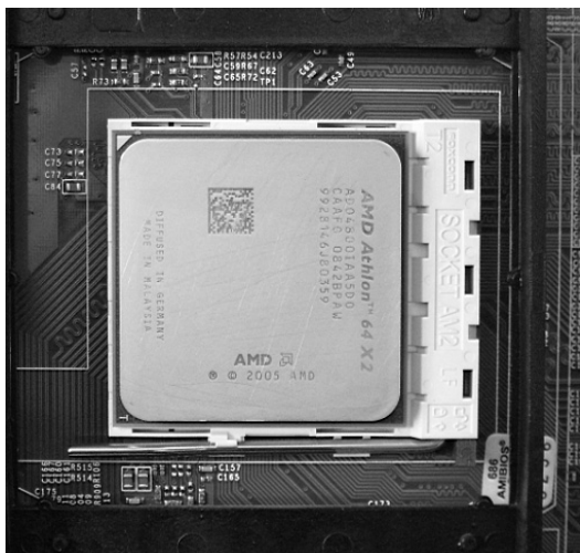
图 2-5 CPU 安装到插座图
