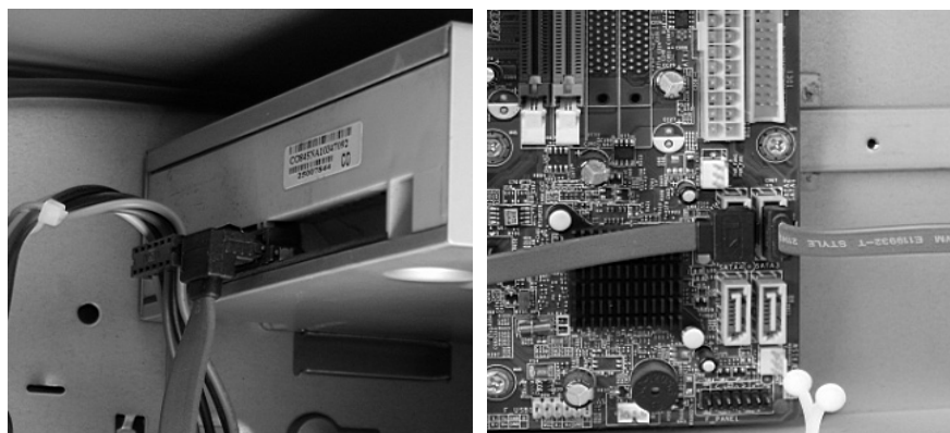
图 2-16 连接光驱数据线与电源线图
